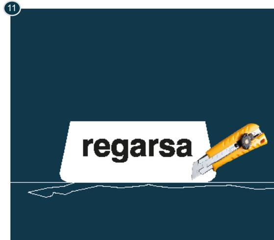
Eliminar el sobrante de revestimiento en techo y rodapié con una espátula ancha y un cutter, desplazando la espátula sin levantar el cutter.
